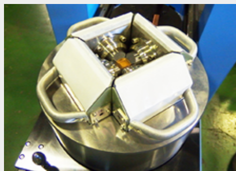
ガイドブロック製作実績 DIA型 1800kN~3500kN用 Kawai型 1800kN~15000kN用 (Walker-type)
